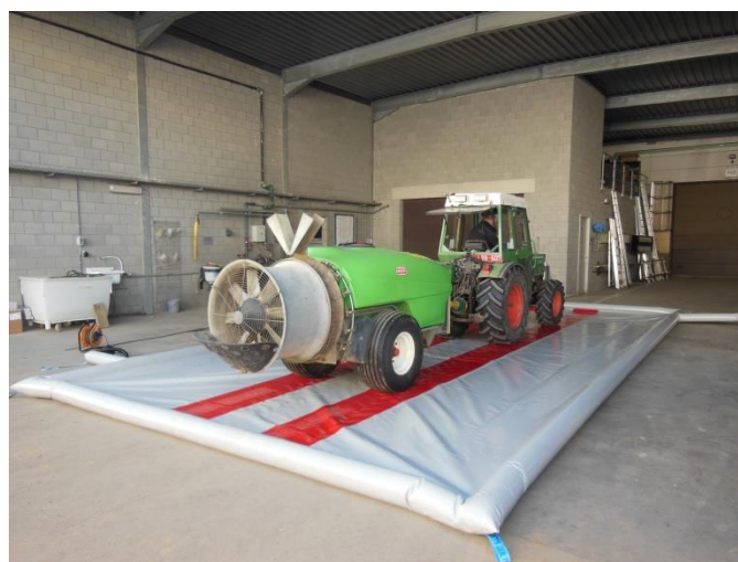
Figuur 1: Mobiele vul- en spoelplaats
